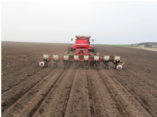
Billede 2. Såning af majs oven i sporet efter nedfældningstanden. Foto: Henning Sjørsløv Lyngvig, VFL.
