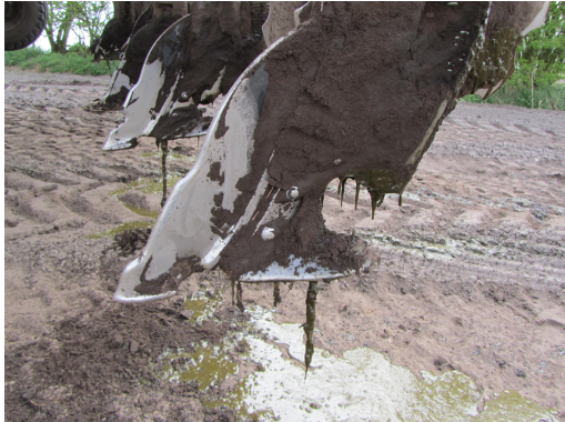
Billede 1. Vingeskær på Focus CS. Gyllen er placeret i et bånd på ca. 15 cm. Foto: Henning Sjørsløv Lyngvig, VFL.
